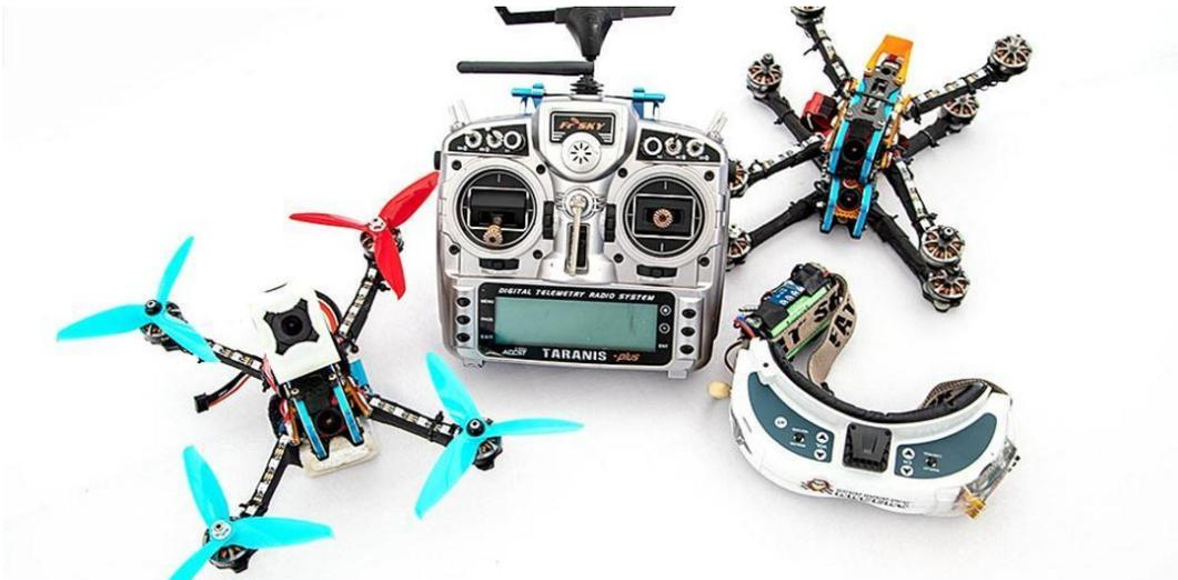
Для управления гоночным дроном нужен пульт управления, внешне чем-то напоминающий джойстик, а для контроля за полетом нужны специальные FPV-очки или шлем. Чтобы в этих очках появилось изображение, дрон должен быть оборудован видеопередатчиком и подключенной к нему камерой.
