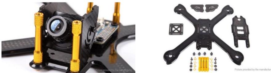
Наиболее распространенным материалом для изготовления рам является карбон. Он очень жесткий и прочный, и при этом легкий. В нашей стране также широко распространены рамы из стеклотекстолита. Он незначительно уступает карбону по жесткости и весу, но зато имеет в два раза меньшую стоимость и отлично подходит для начинающих пилотов и тренировок любителей.
