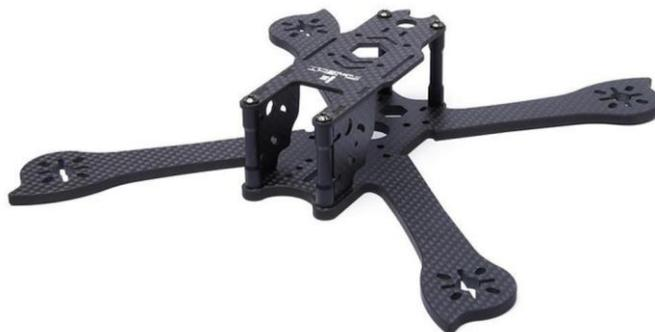
Рама – это основа квадрокоптера. На ней размещаются все остальные его компоненты, она защищает электронику от повреждений. Чаще всего рамы имеют крестообразную форму. В наиболее простом и распространенном исполнении рама состоит из двух пластин – верхней и нижней. Между собой они соединены алюминиевыми или титановыми стойками, а также двумя дополнительными боковыми пластинами. Верхняя пластина вместе со стойками называется башней.
