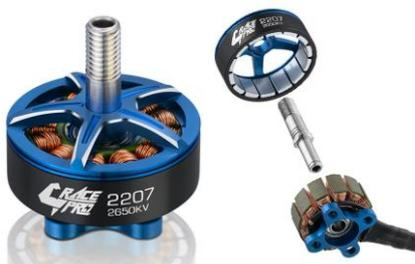
Моторы бывают двух типов: коллекторные(щеточные) и бесколлекторные. В гоночных дронах используют бесколлекторные моторы. На один квадрокоптер устанавливают четыре мотора с одинаковыми характеристиками.
