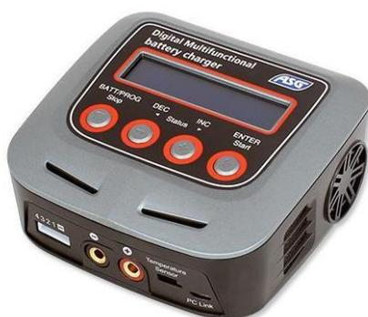
Для зарядки аккумуляторов необходимо использовать только специализированные зарядные устройства, которые созданы для работы с литий-полимерными батареями. Зарядное устройство может пригодиться не только для зарядки других аккумуляторов, кроме как для квадрокоптера, например, для аппарата управления или очков.
